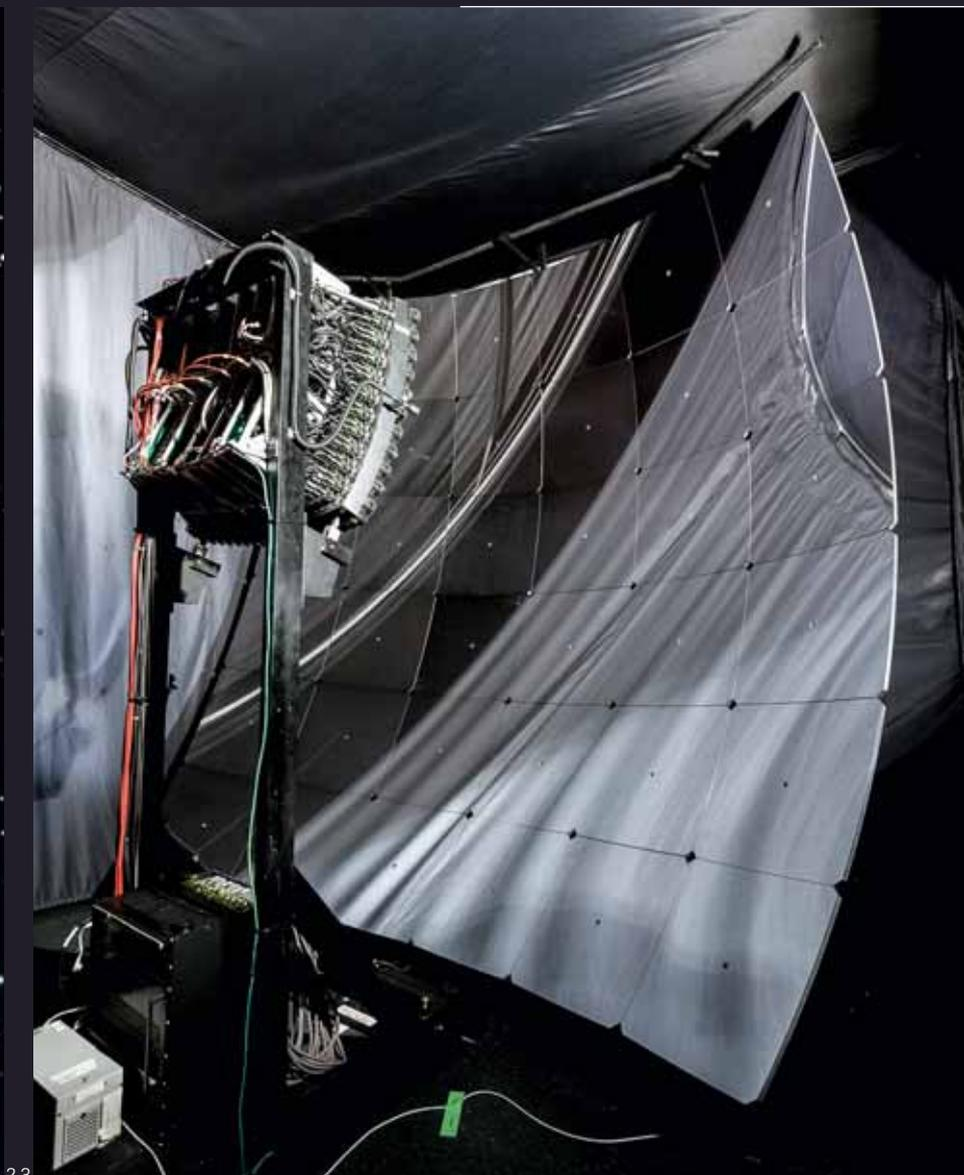
3. Les grands miroirs de ce télescope à fluorescence concentrent la lumière émise par les « gerbes atmosphériques », cascades de particules générées par la collision des rayons cosmiques avec l'atmosphère, et la renvoient sur une caméra composée de tubes photomultiplicateurs qui comptent les photons émis.
