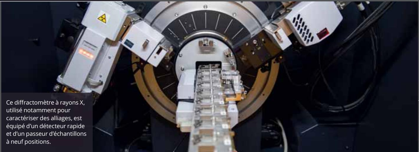
Ce diffractomètre à rayons X, utilisé notamment pour caractériser des alliages, est équipé d'un détecteur rapide et d'un passeur d'échantillons à neuf positions.
